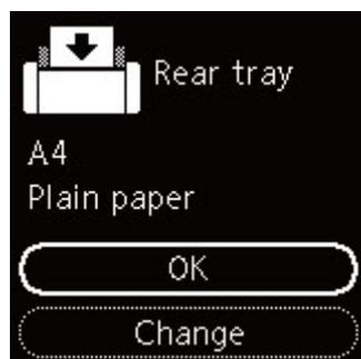
Wenn das Seitenformat auf der LCD-Anzeige mit dem Format des in das hintere Fach eingelegten Papiers übereinstimmt, wählen Sie **OK** aus.
