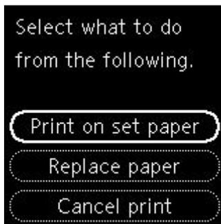
Wählen Sie mit den Tasten ▲ ▼ die entsprechende Maßnahme aus und drücken Sie dann die Taste **OK** am Drucker.
